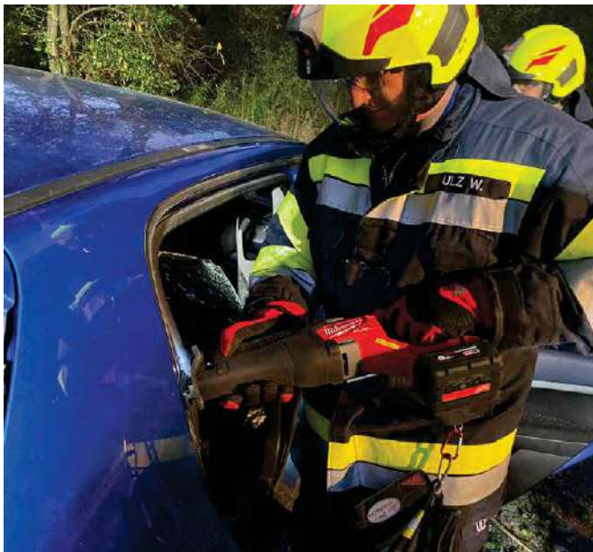
Öffnung eines Autos mit der Säbelsäge
