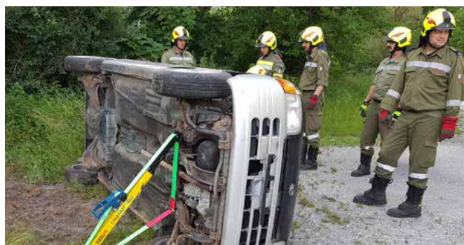
Sicherung eines Fahrzeuges mit „Stab Fast“
